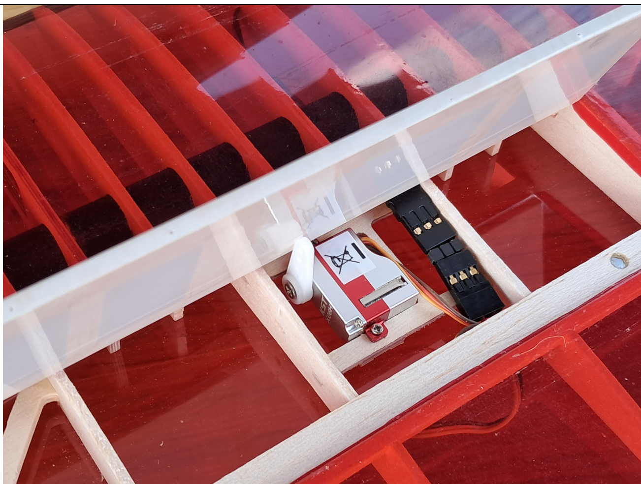
Servo brz. Pro funkci úplně stačí pohybovat pákou na servu, v rozích brzd jsou 2 malé magnety. Nic víc.
